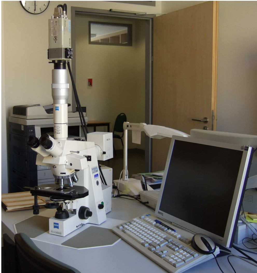
Abbildung 1: Durchlichtmikroskop, Kamera und elektronische Bilddarstellung
