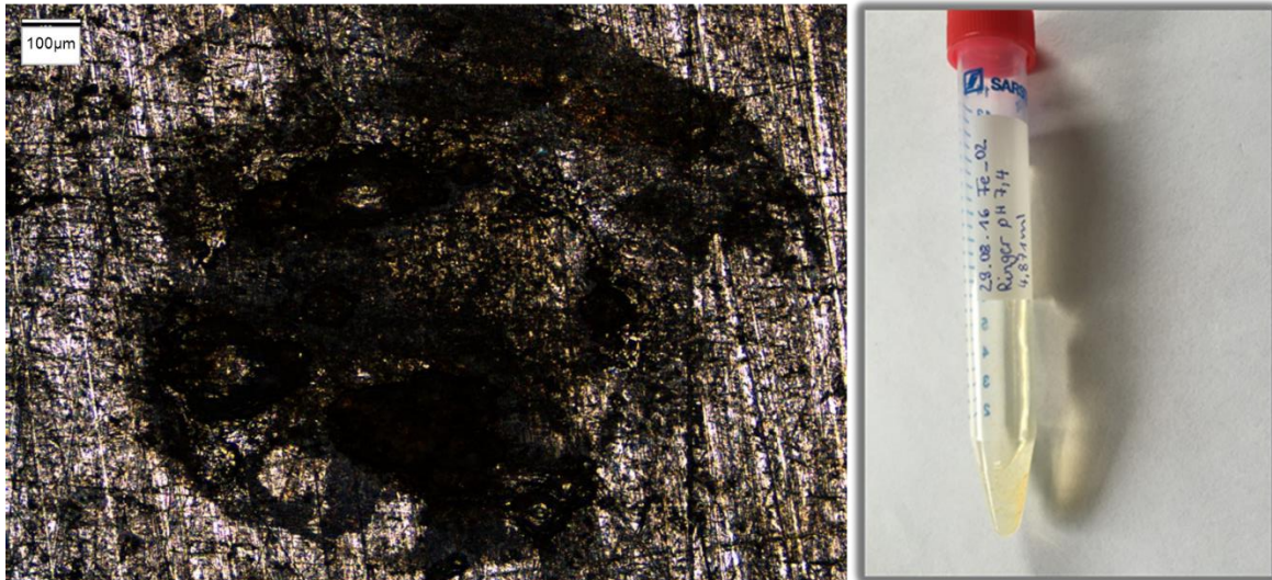
Abbildung 30 Lichtmikroskopische Aufnahme der Messfläche von Eisen mit dem Alicona IF; links in BME; und rechts: fotografische Aufnahme der rotbraunen Verfärbung der Ringerlösung pH 7,4 nach elektrochemischer Belastung [Foto: Patricia Kunert]. In BME ist eine ungleichmäßige Oberfläche erkennbar
