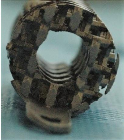
Abbildung 2: Darstellung eines Titan Mesh Scaffolds im Querschnitt. Innen mit der zentralen Pore und Außen mit der bienenwabenartigen Meshstruktur.
