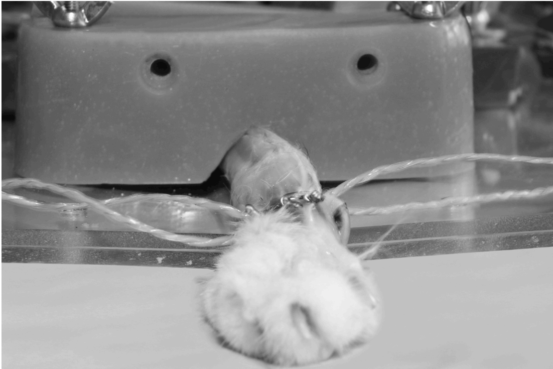
Abbildung 8f: Unterarm einer Katze in trapezförmig ausgeschnittenen Halterungen (erstes Prisma) auf der Nut zweier sich durchbiegender Plexiglasplatten (zweites Prisma) fixiert.
