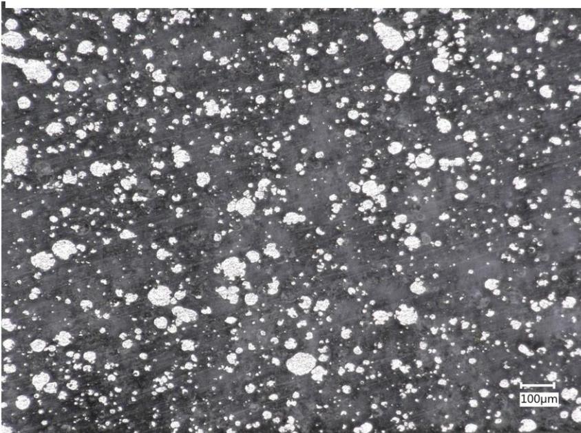
Abb. 5: Lichtmikroskopische Aufnahme der angeschliffenen Oberfläche eines gepressten PLA/30Mg-Pellets. Angeschliffene Magnesiumpartikel sind silbrig glänzend zu erkennen. Sie umgebende PLA-Matrix imponiert gräulich. Das Verhältnis zwischen Magnesium- und PLA-Anteil, wie auch die Form und Größenverteilung der Magnesiumpartikel ist gut abschätzbar. (Zimmermann et al., 2018)
