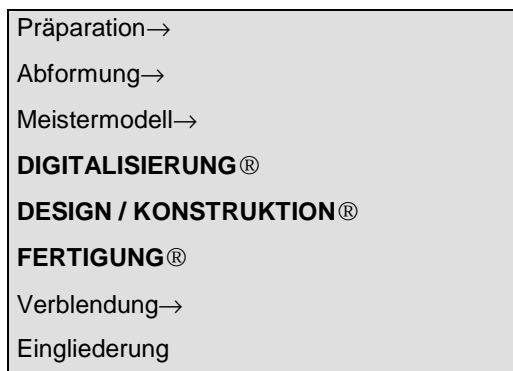
Abb.2.7 Flussdiagramm einer CAD/CAM-Herstellung
