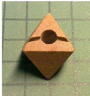
Abbildung 22: Geschlitzter Oktaeder (Kantenlänge 10 mm) für Hochdruck-/Hochtemperaturexperimente.
