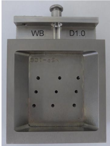
**Abbildung 8: Multipinhole-Kollimator**
