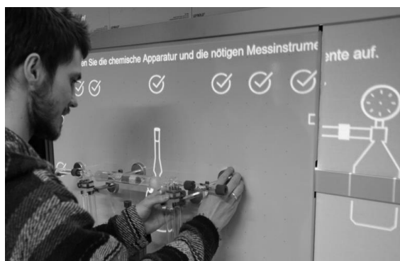
Abb.2: Ein Proband wird beim Aufbau eines Chemie-experiments unterstützt. Ortsnah werden ihm Hinweise für das weitere Vorgehen gegeben.
