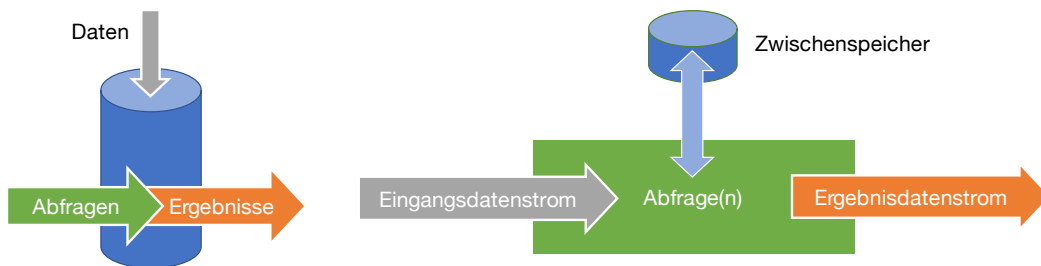
Abbildung 3.10: Vergleich des Funktionsprinzips von Datenbanksystemen (links) und Datenstromsystemen (rechts).
