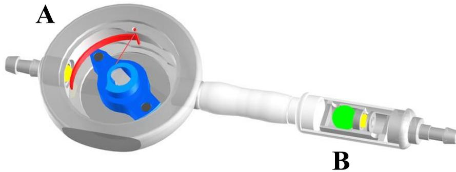
Abbildung 4: Das proGAV-Ventil. A: verstellbare Differenzialdruckeinheit.
