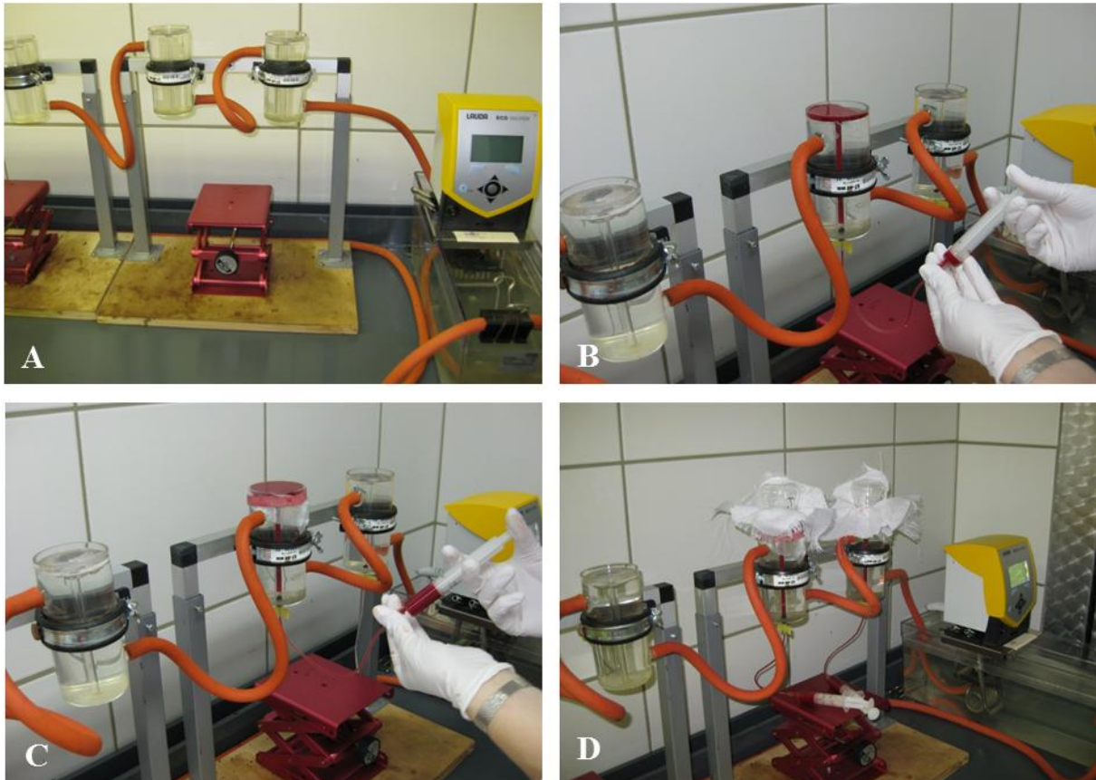
Abb. 15: Aufbau der Blutfütterungsanlage. A Holzsockel mit Halterungen und Fütterungseinheiten (leer), daran angeschlossen das Wärmethermostat mit Pumpfunktion im Transparentbad, B Befüllen einer Fütterungseinheit mittels Spritzen-Katheter-Schlauch-System, C Abdeckung der befüllten Vertiefung mit doppelt gedehntem Parafilm und einem breiten Gummiband, D mit Gaze verschlossene Wanzengläser auf die Membranen gesetzt.
