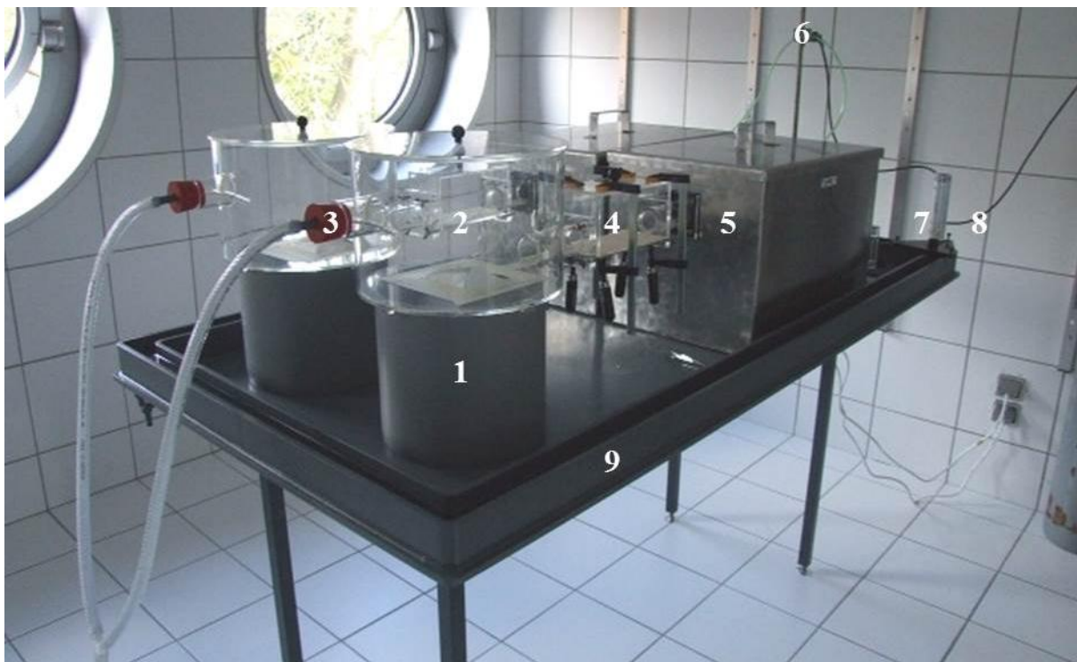
Abb. 9: Aufbau der Wahlversuchsanlage. 1 Sockel des Plexiglasbehälters, 2 Plexiglasbehälter mit Wanzentische, 3 Plexiglasrohr mit Stopfen und Absaugschlauch ( \varnothing 1 cm), 4 Plexiglaskasten, verbunden mit dem Plexiglasbehälter, 5 Stahlbehälter mit Deckel, 6 Plastikschlauch zur CO 2 Zufuhr ( \varnothing 0,5 cm) hinter dem Durchflussmesser, 7 Gasdurchflussmesser, 8 Plastikschlauch für die CO 2 Zufuhr ( \varnothing 0,5 cm) vor dem Durchflussmesser, 9 Spezialtisch mit Paraffinöl in der Rinne am Rand.
