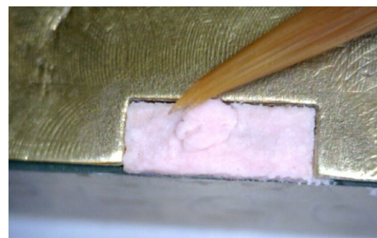
Abb. 21: Auftragen der Keramikmasse
