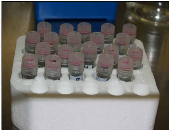
Abb. 9: Cryo-Tubes mit individuell angepasster Silikon-Kappe im verschließbaren Deckel, vorbereitet zur Inkubation im Brutschrank.
