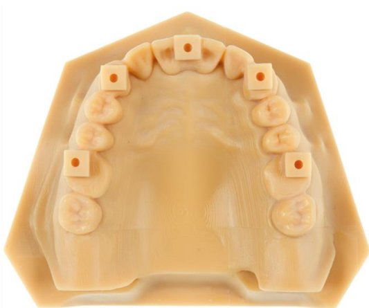
Abb. 1: Studienmodell aus FotoDent-LED® Harz mit fünf Referenzzyklindern als Messpunkten
