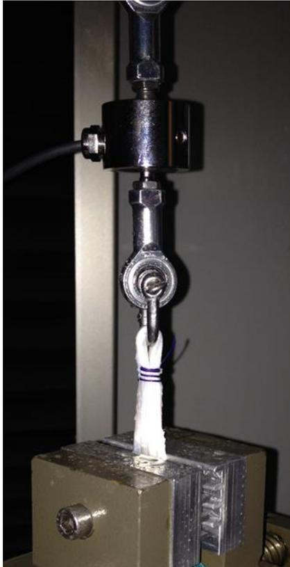
**Abbildung 11:** Versuchsaufbau der isolierten Transplantattestung. Das Transplantat ist in einer Aluminiumklemme fixiert, welche mit einer Materialprüfmaschine verschraubt ist. Das geschlungene Ende des Transplantates ist über einen Schäkkel mit dem Messsensor verbunden.
