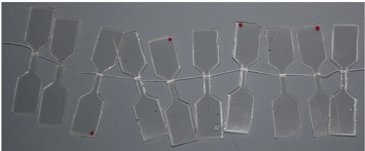
Abb. 8 Mit einem Bindfaden aneinander gebundene Prüfkörper (hier: Schulterstäbe).
