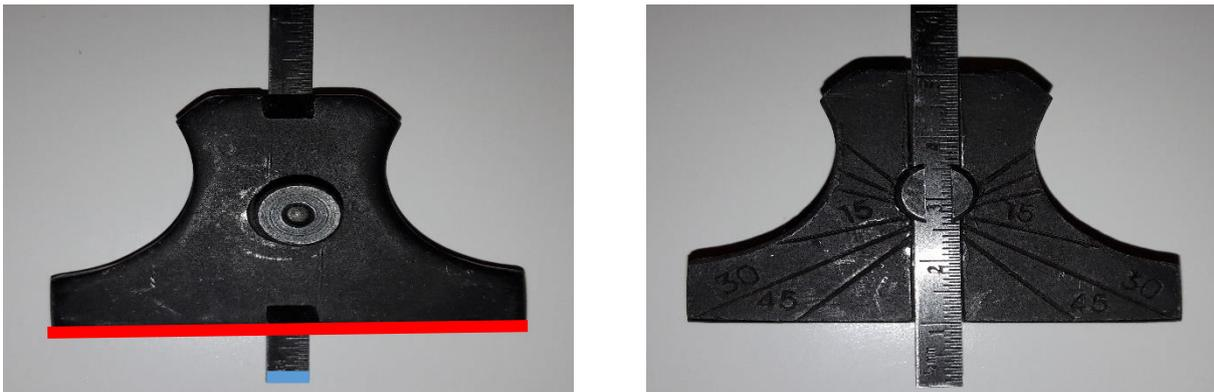
**Abbildung 14 und 15:** Darstellung Handstück des Tiefenlehremessgerätes für die Ausmessung der Orbita.
