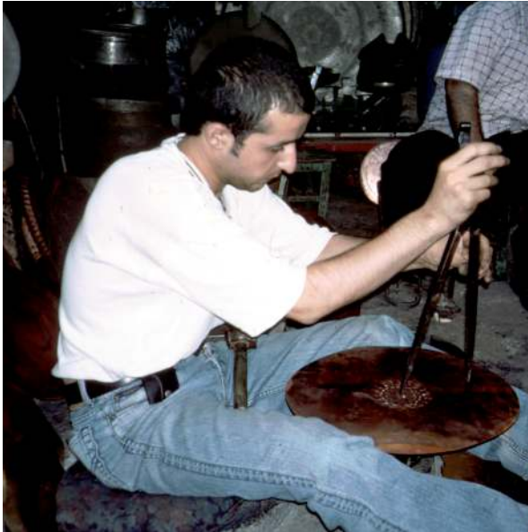
Abb. 4 Nutzung eines großen Zirkels zum Vorzeichnen äußerer Punzierungen.
