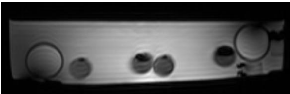
Abbildung 1.3 Darmphantom transversal: T1w SE großer Schlauch mit 0,25 \mu \text{ mol/l} GdDTPA dotiert. Kleiner Schlauch mit Leitungswasser befüllt. Beide Schläuche eingetaucht in flüssiges Speiseöl.
