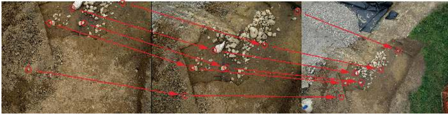
Abb. 1 Voraussetzung für das Structure-from-Motion-Verfahren sind aus unterschiedlichen Blickwinkeln aufgenommene, sich stark überlappende Photographien derselben Szene. In diesen werden charakteristische Punkte (Kreise) ermittelt, die über die einzelnen Bilder miteinander verknüpft werden (Pfeile).
