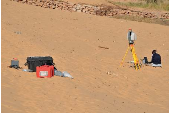
Abb. 3 Leica ScanStation 2 im Einsatz.
