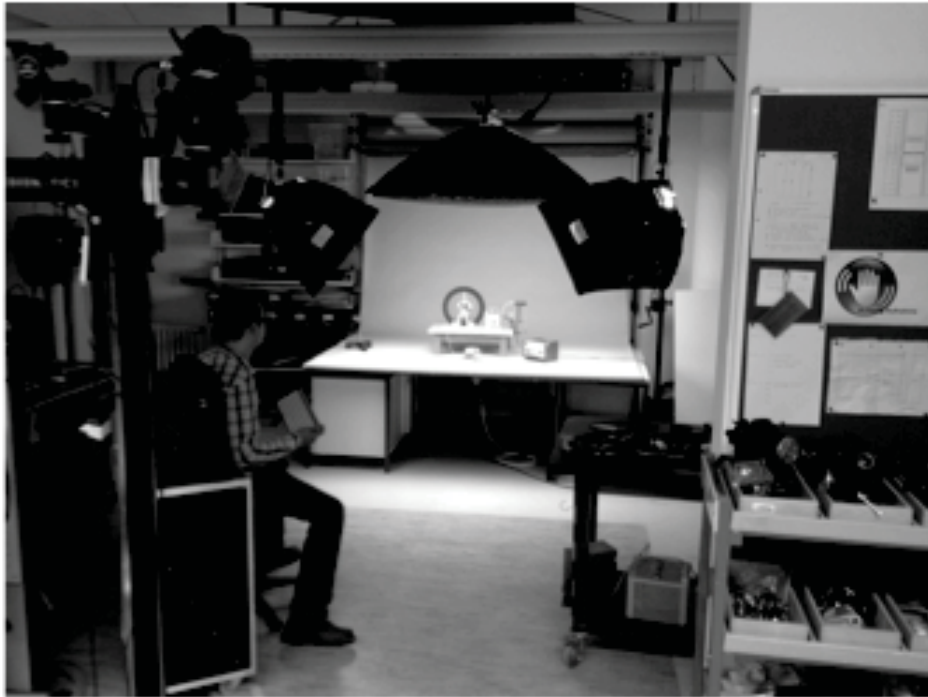
Abbildung 2: Blick in ein IBE-Labor der AG Didaktik der Physik an der Freien Universität Berlin. Links oben ist die digitale Aufnahmekamera zu erkennen, die für das Stopp-Trick-Animationsverfahren auf einem schweren Säulenstativ fixiert ist. Der Experimentator variiert systematisch die Parameterwerte im Experiment und fotografiert den zugehörigen Zustand. Die computergesteuerte Kamera wird dabei fernausgelöst.
