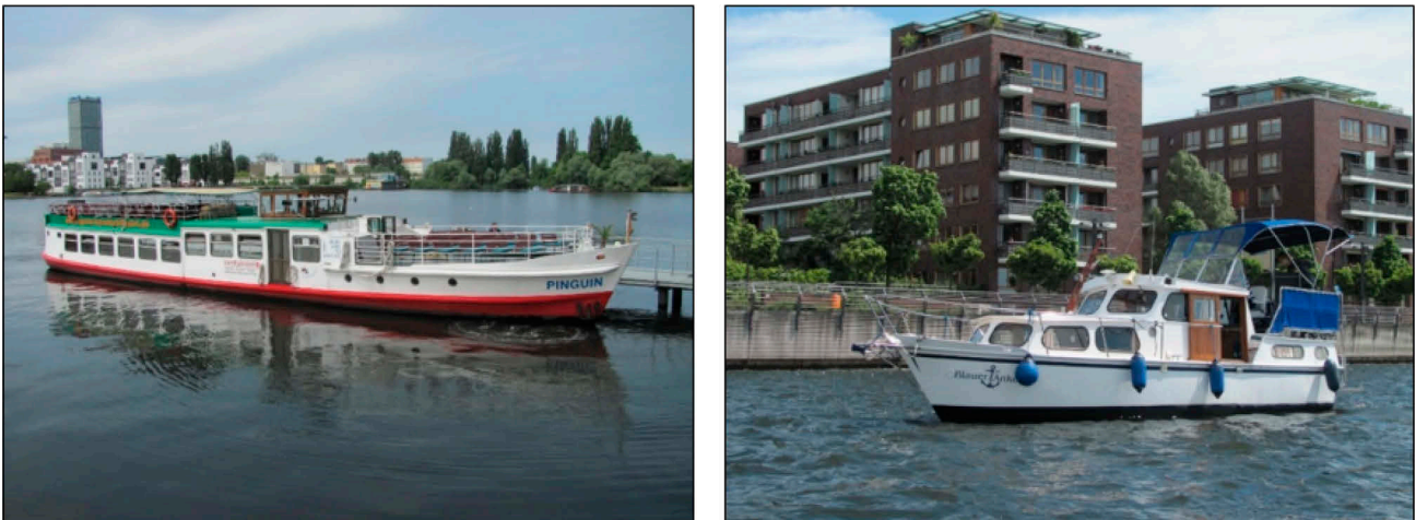
Abb. 17: Die für die Versuche zur schiffsinduzierten Remobilisierung der Sedimente verwendeten Schiffstypen: Fahrgastschiff (links), Motoryacht (rechts)
