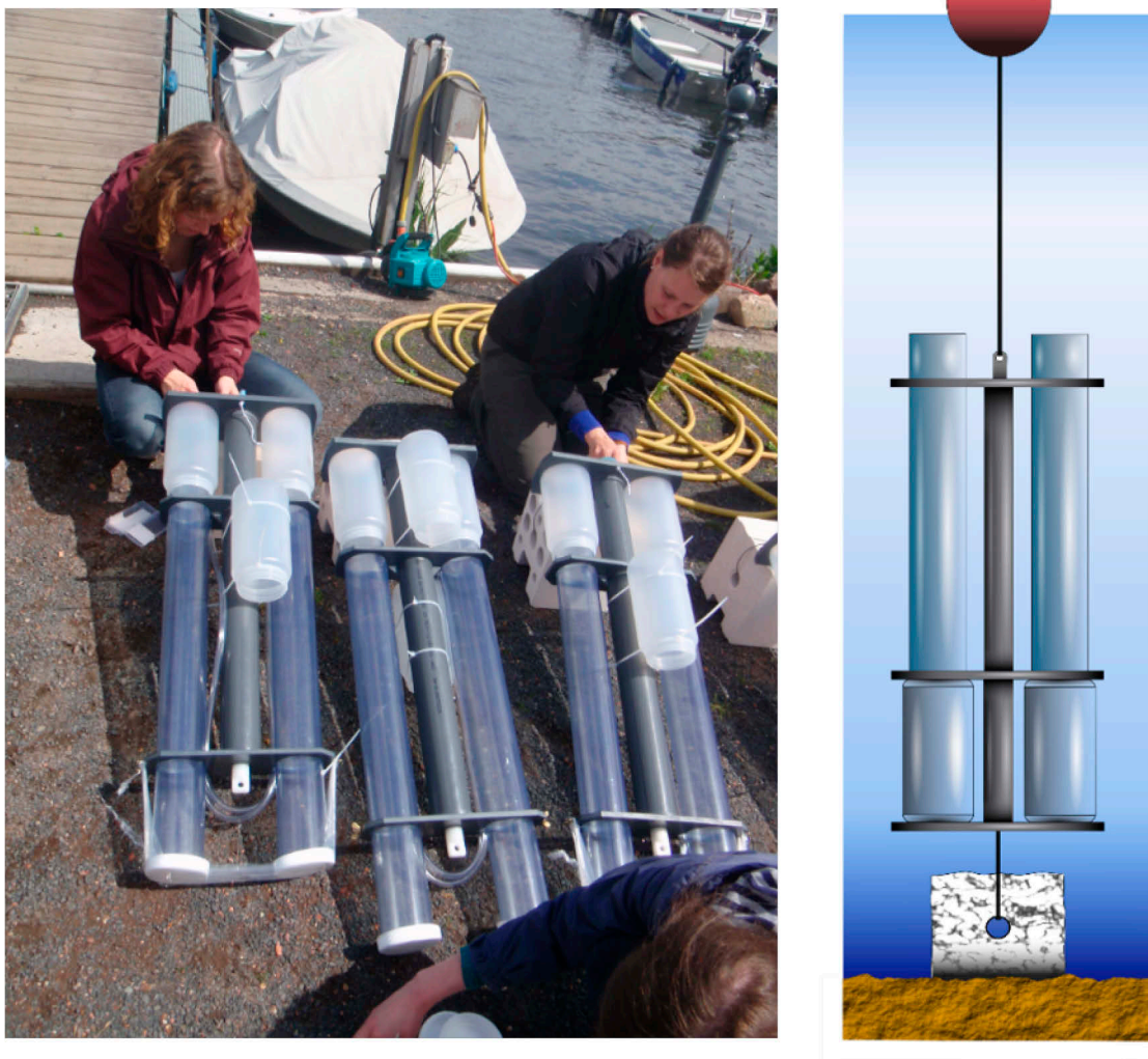
Abb. 13: Montage der Sedimentfallen (links) und Installation im Gewässer (rechts)
