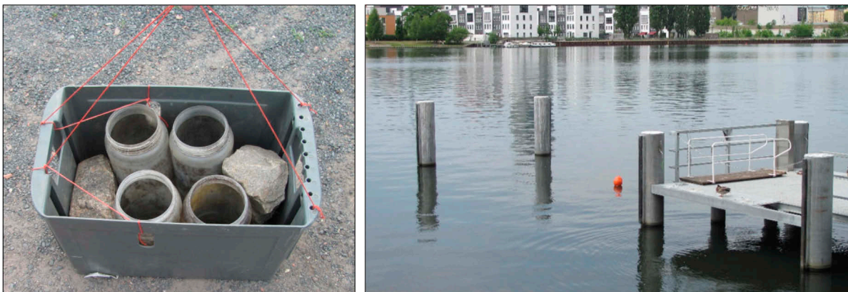
Abb. 19: Die für die Versuche zur schiffsinduzierten Remobilisierung von Sedimenten verwendete Sedimentfallenkonstruktion (links) und Lage der Sedimentfalle (Boje) an der Anlegestelle Rummelsburger See
