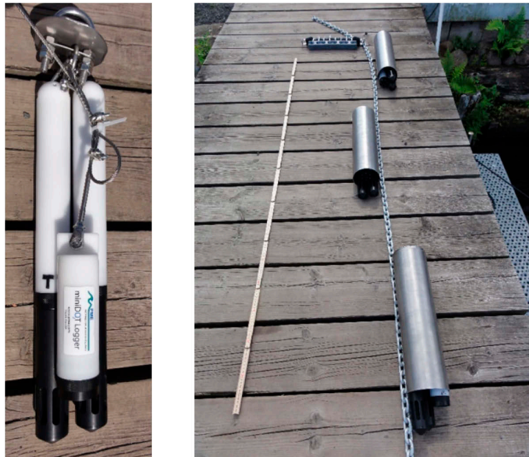
Abb. 15: Sensoren der Multisensorkette (links) und Unterwasserkonstruktion (rechts)
