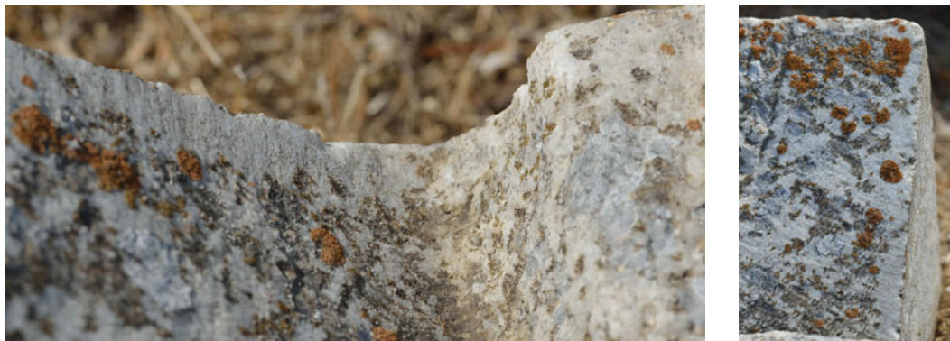
Abb. 6 | Bearbeitung der Oberfläche des Objekts auf der Vorderseite. Während an den Außenkanten in bis zu 2 cm breiten Streifen die Oberfläche glatt ist, zeigen sich in der Mitte der Flächen die Spuren der Zähne eines Meißels. BSDP0010, Ausschnitte aus Abbildungen DelosDSC_0551-655.jpg und DelosDSC_0536-640.jpg
