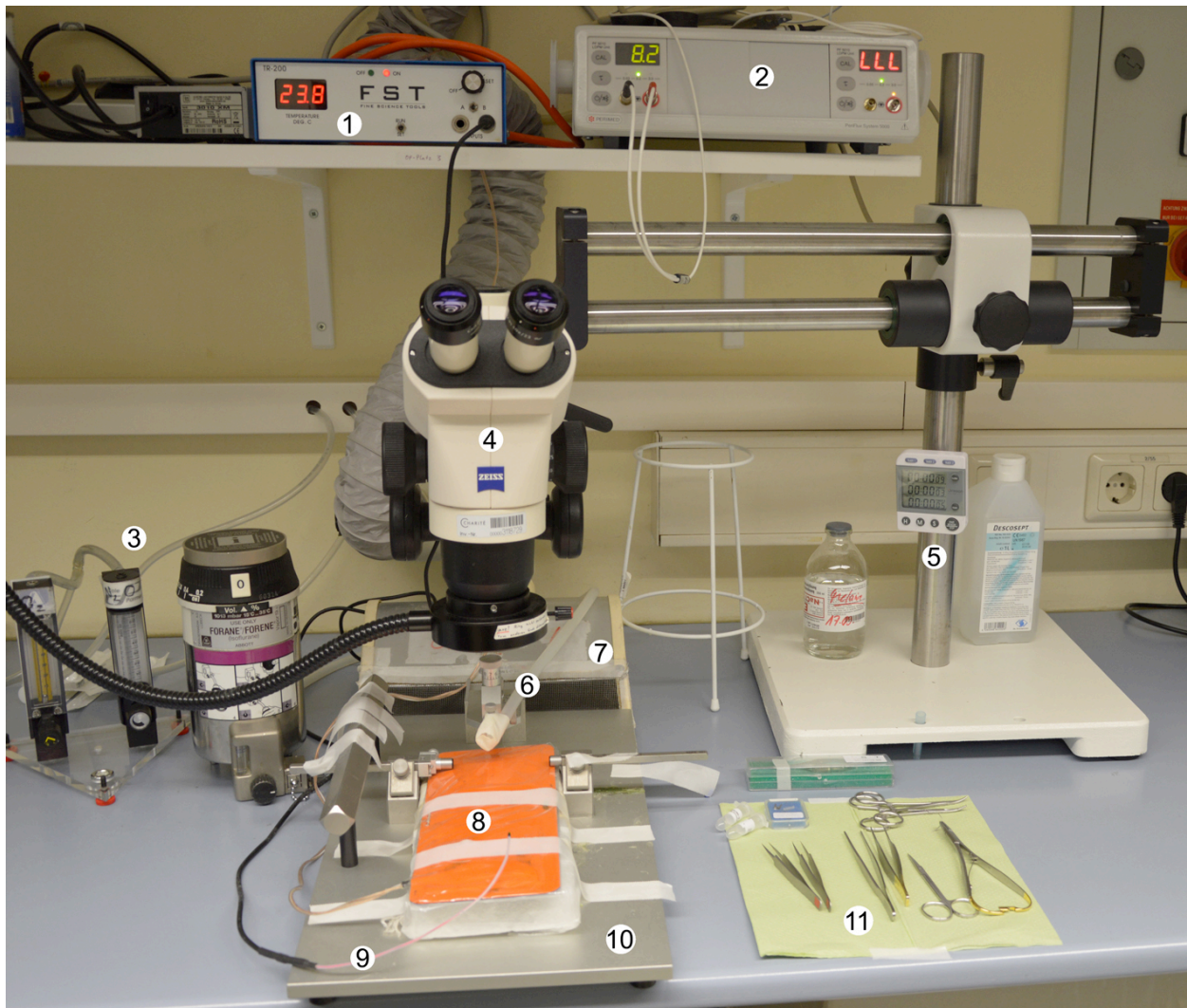
Abbildung 3: Tierexperimenteller Arbeitsplatz. Das Foto zeigt eine Übersichtsaufnahme des experimentellen Arbeitsplatzes mit Anordnung der wichtigsten Messeinheiten und Instrumente, wie sie für die Durchführung der Versuche gebraucht wurden. Von oben nach unten sind die Messeinheit für die rektale Temperatur (inklusive des Temperaturreglers für die Heizmatte) (1), die Messeinheit des Laser-Dopplersignals (2), die Narkosegasmischeinheit (3), das Operationsmikroskop (4), die Stoppuhr (5), die Zuführung der Narkosegase zur Gesichtsmaske (6), die Absaugvorrichtung für austretende Narkosegase (7), die Heizmatte (8), der rektale Temperaturfühler (9), der stereotaktische Rahmen (10), sowie die chirurgischen Instrumente (11) zu erkennen.
