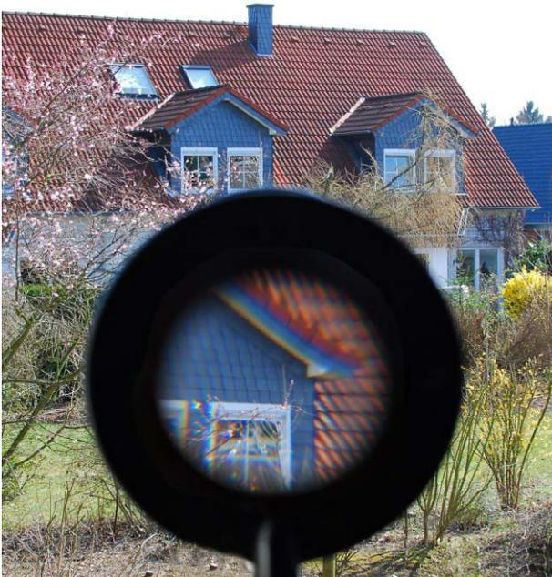
Abb. 4: Blick durch die zwei hintereinander angeordneten Linsen des Modell-Teleskops
