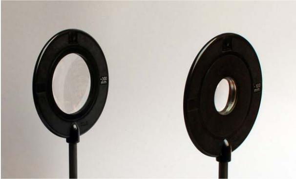
Abb. 3: Hauptbestandteile eines Teleskops; rechts das Okular, links das Objektiv
