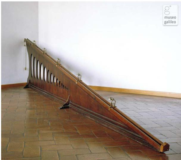
Abb. 6: Nachgebaute schiefe Ebene im Museo Galileo in Florenz; als Zeitmesser verwendete er am oberen Ende der schiefen Ebene ein Pendel, aber auch eine „Wasseruhr“, auf die hier nicht eingegangen wird.
