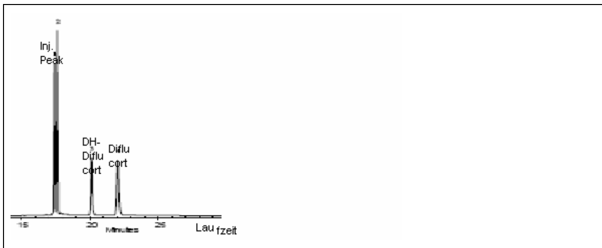
Abbildung 12: HPLC-Chromatogramm von Diflucortolon und 11-DH-Diflucortolon
