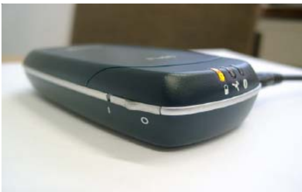
Abbildung 7 - GPS-Empfänger; Quelle: Kracht 2005
