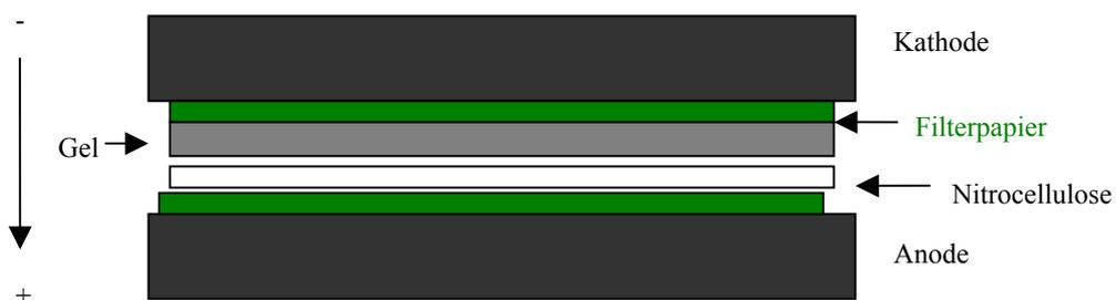
**Abbildung 14: Anordnung des Gels, der Nitrocellulosemembran und der Filter in der Blotapparatur**
