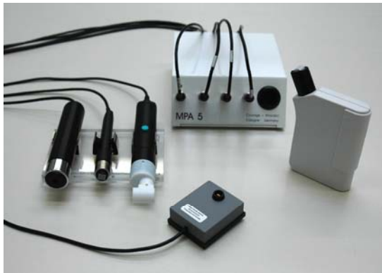
Abbildung 5: Multi Probe Adapter ® 5 , Courage + Khazaka electronic GmbH mit den Geräten (von rechts) Sebumeter ® , Room condition sensor ® , Tewameter ® , Corneometer ® und Mexameter ® (diese Sonde wurde in der vorliegenden Studie nicht verwendet).
