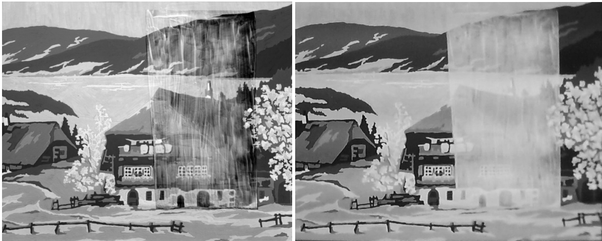
Abb. 13: Links: Gemäldeuntermalung sichtbar gemacht mit der Kamera Leaf-Aptus 40 MPx und Wratten87-Filter. Rechts: Aufnahme mit modifizierter Webcam 8 MPx, Fuji (M) Diapositiv als Filter. Beide Fotos wurden leicht nachbearbeitet (Kontrastverstärkung). [7]
