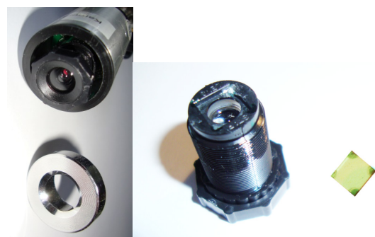
Abb. 7: Links: Objektiv einer Webcam mit abgenommener Objektivkappe. Rechts: Rückseite des Objektivs und entferntem Filter, der noch die Klebestellen aufweist
