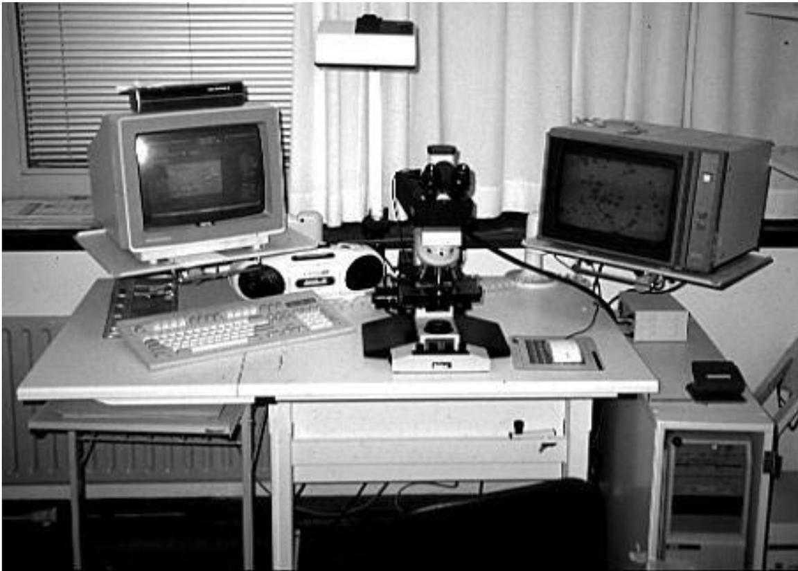
Abb. 1 Bildanalyse-System CAS 200
