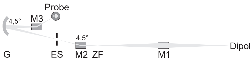
Abbildung 2.4: Schematische Darstellung des Monochromators 3m-NIM-1. Mit Gitter G, Eintrittsspalt ES, Zwischenfokus ZF und Spiegeln M1, M2 und M3.
