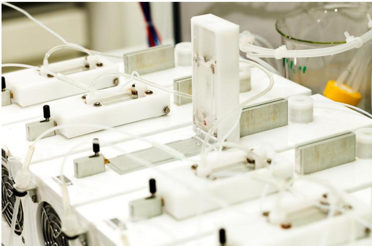
Abbildung 17: Anlage zur automatisierten Inkubation von Slides. Die Slides werden in die Anlage gelegt und durch Herunterklappen des Deckels arretiert. Im Deckel befindet sich ein O-Ring, welcher gleichzeitig die Inkubationsfläche bildet und diese gleichzeitig abdichtet.
