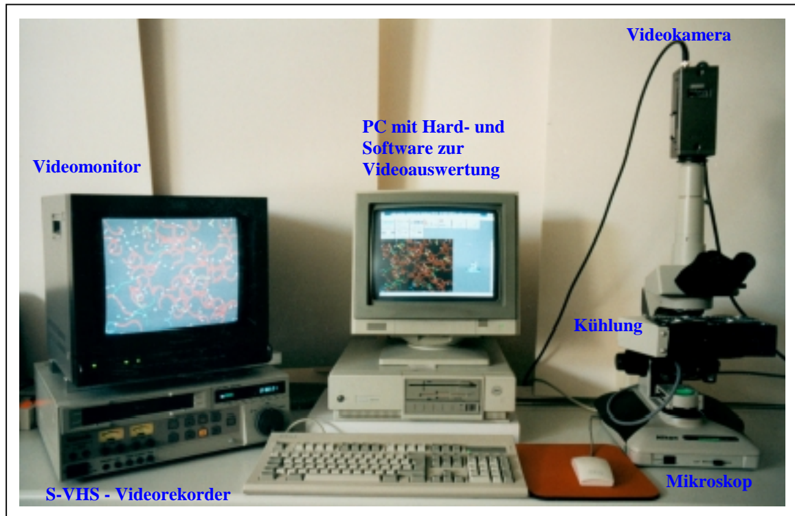
Abbildung 6: Verwendetes System für die computergestützte Videomikrographie (CASA)
