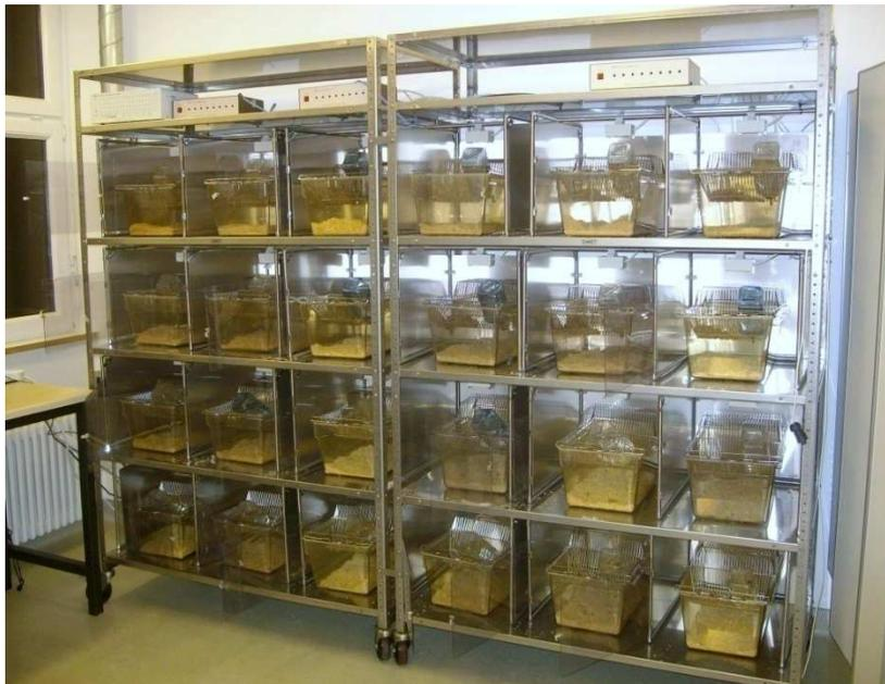
Abb. 2.1: Supermex-Lokomotor System mit 24 Einzelkäfigen
