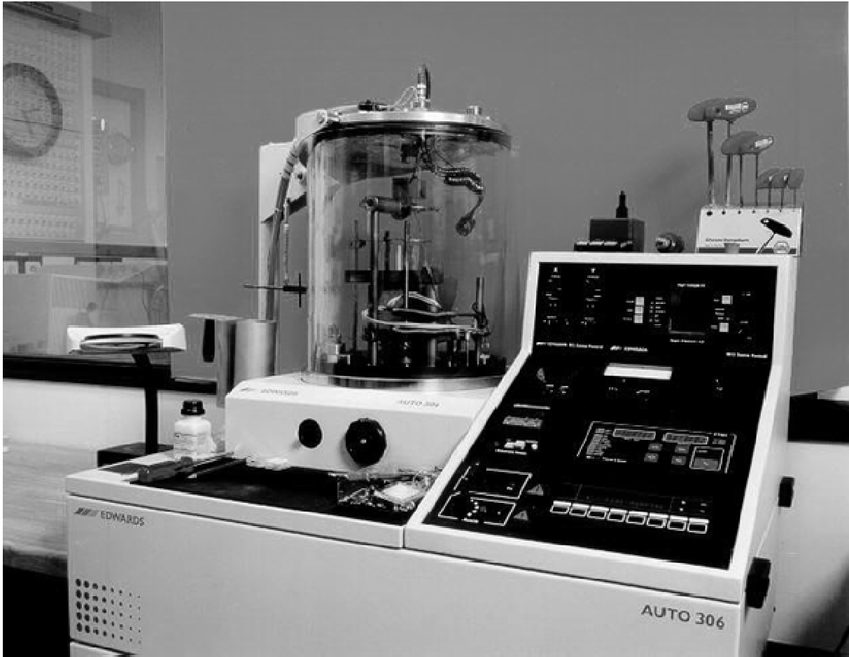
Abbildung 20: Edwards Bedampfungseinheit. Quelle: www.gsi.de .
