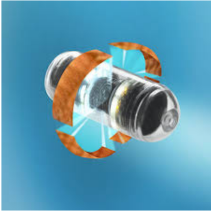
Abbildung 2: Makroskopischer Aufbau der CapsoCam SV-1
