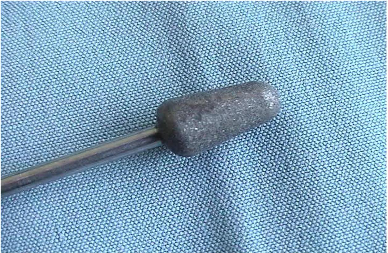
Abb. 2.4.4: konischer Diamantschleifkopf
