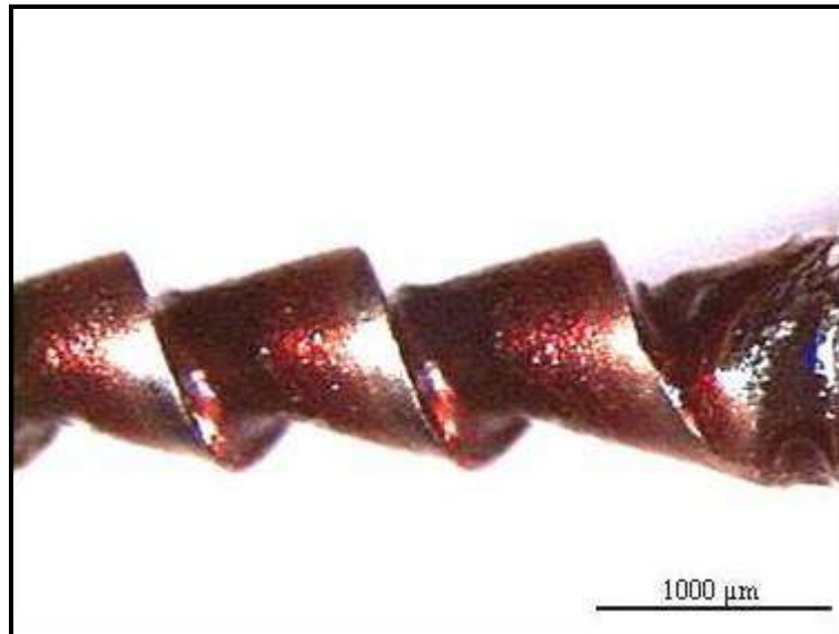
Abb. 4.5: Hedström-Feile mit Testanschmutzung.
