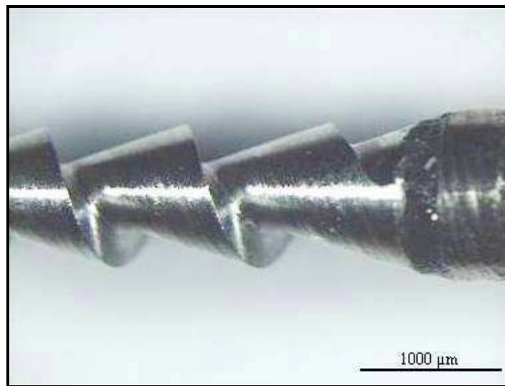
Abb. 5.5: Hedström-Feile nach fünfminütiger Einweichzeit in einem mit 0,04 % Polihexanid-Lösung befüllten Interim-Stand.
