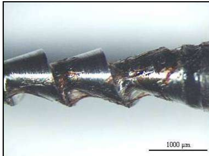
Abb. 5.3: Hedström-Feile nach fünfminütiger Einweichzeit in einem mit 1 % NaOCl-Lösung befüllten Interim-Stand.
