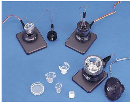
Abbildung 4: Endohm-Messkammer mit aufgesetztem Deckel inklusiver integrierter Elektrode sowie eingelegtem Insert (WPI, 2006)
