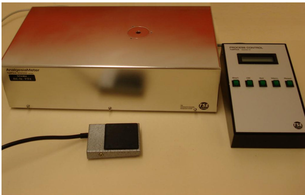
Abb. 7: Tail-Flick-Gerät (AnalgesiaMeter, TSE-Systems, Bad Homburg). In dem Messgerät befindet sich eine Lampe, die einen fokussierten Lichtstrahl mit hohem Infrarotanteil erzeugt (schwarzer Kreis), der auf den darauf liegenden unfixierten Rattenschwanz einen Hitzereiz ausübt.
