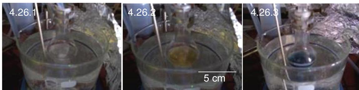
**Abbildung 4.26:** Farbumschläge während der Synthese von trigonalen Silbernanoprismen vor der Zugabe von  $\text{NaBH}_4$  (s. Abbildung 4.26.1), nach der Zugabe von  $\text{NaBH}_4$  (s. Abbildung 4.26.2) und am Ende der Reaktion (s. Abbildung 4.26.3).
