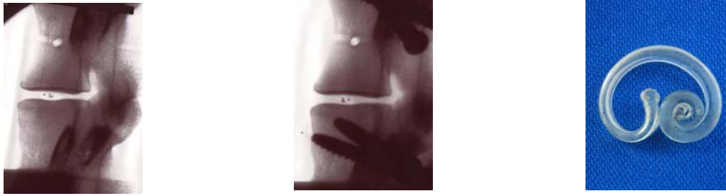
Abbildung 38, 39 und 40: Nach der Testung deutlich verformtes Nucleusersatz-Implantat (rechtes Bild). Bereits in der radiologischen Kontrolle ist eine deutliche Positionsveränderung der Tantalum-Kügelchen zu erkennen. (linkes Bild vor der Testung, mittleres Bild danach. Hier sind aus logistischen Gründen bereits die Schrauben des PDSS implantiert)
