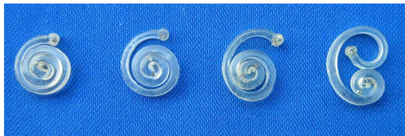
Abbildung 41: Unterschiedlicher Verformungsgrad der Schaf-Implantate durch die Testung. Ganz links ein nicht verändertes Spiralimplantat
