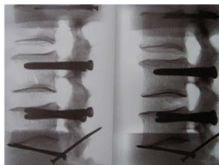
Abbildung 36 und 37: Humanes Präparat links vor der Testung, rechts danach. Das Spiralimplantat ist in situ verblieben. Die Position der Tantalum-Kügelchen hat sich jedoch leicht verändert, hier eher im Sinne einer Optimierung der Position im Bandscheibenfach. Die Spirale zeigte nach ihrer Entfernung keinerlei Formveränderung.
