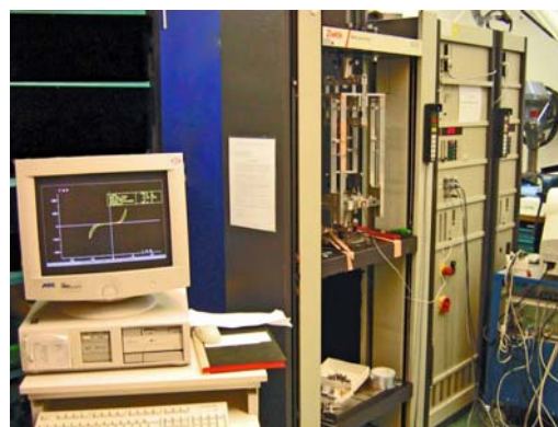
Abbildung 20: Zwick-Materialprüfmaschine. Am linken Bildrand ist der Zwick-Computerbildschirm mit der Kraft-Dislokations-Kurve der Traverse zu sehen. Am rechten Bildrand der Computer mit dem Registrierungsprogramm (Catman 4.5). Zentral der eingebaute Testaufbau (ohne Präparat).
