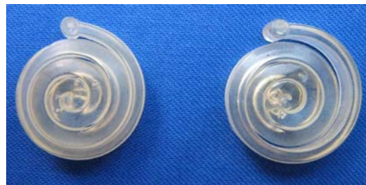
Abbildung 42: Humane Spiralimplantate nach der Testung. Das linke ist unverändert, das rechte zeigt eine leichte Auflockerung der Spiralwindung.
