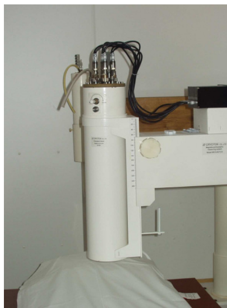
Abb. 11: Messanordnung auf der Thoraxoberfläche und Abbildung des 7 Kanal-Magnetographen (Campus Berlin-Buch aus „Cardiac magnetic field map topology quantified by Kullback-Leiber“; Schirdewan A, et al; 2007; American Institute of Physics; 17,015118-1).
