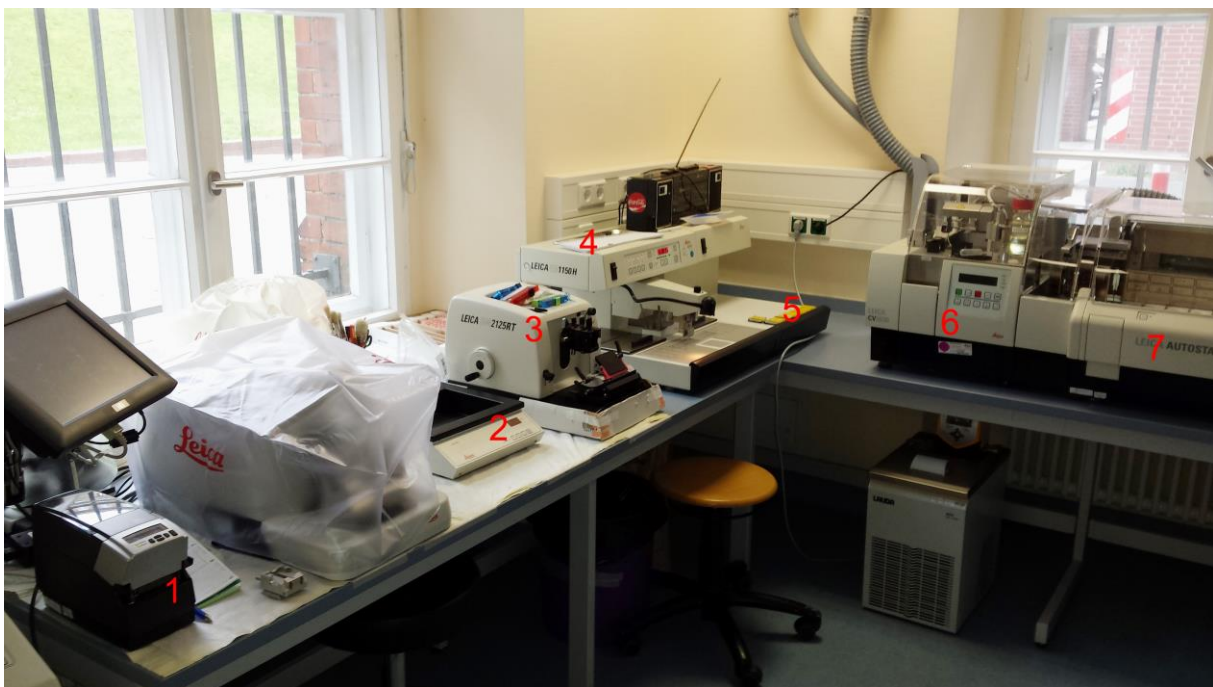
Abbildung 14: Arbeitsplatz im Labor , 1 – Etikettendrucker für die Objektträger, 2 – Wasserbad, 3 – Mikrotom, 4 – Paraffinausgussstation, 5 – Kälteplatte mit Präparaten in Stahlblechformen, 6 – Automat zum Eindecken von Objektträgern, 7 – für die HE-Färbung genutzter Färbeautomat
