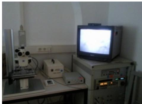
Abbildung 2: Arbeitsplatz Intravitalfluoreszenz-Mikroskopie.
