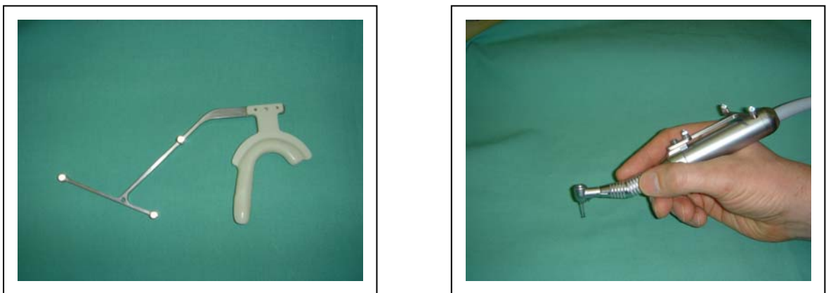
Abbildung 4.2 Optische Tracker: mit drei Glaskugeln zur Referenzierung bzw. Lageerfassung ausgestattet. Diese werden sowohl am chirurg. Handstück als an der Navigationsschiene befestigt. Einfache und reproduzierbare Adaptation der Marker über eine Steck- oder Schraubvorrichtung.
