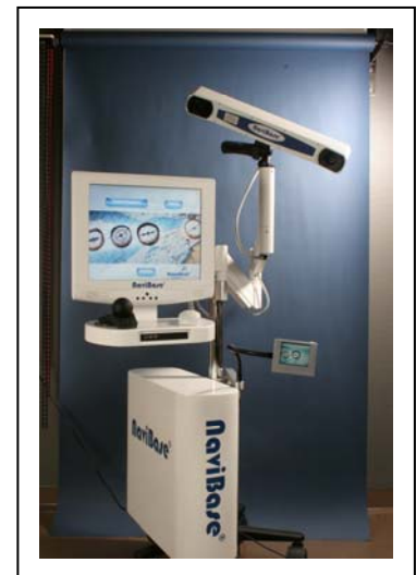
Abbildung 4.1 Links: NaviDoc Praxissystem, Laptop basiert und transportabel Rechts: NaviBase, Kliniksystem auf rollbarer Station Ausstattung jeweils mit Navigationskamera, Steuerrechner, Miniaturmonitor
