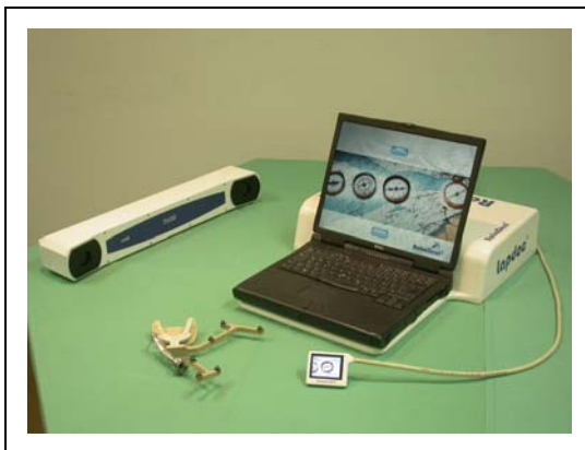
Abbildung 4.1 Links: NaviDoc Praxissystem, Laptop basiert und transportabel Rechts: NaviBase, Kliniksystem auf rollbarer Station Ausstattung jeweils mit Navigationskamera, Steuerrechner, Miniaturmonitor
