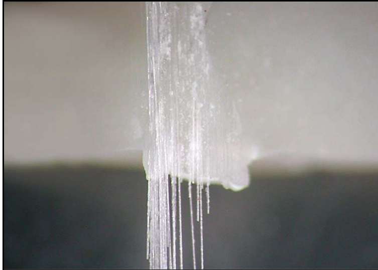
Abb. 14 Rein kohäsives Versagen im Faserstift
