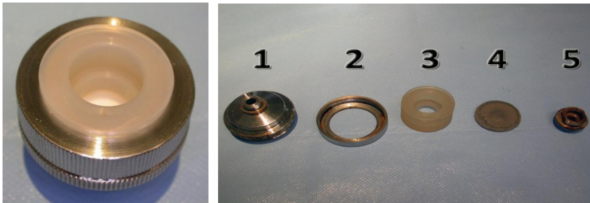
Abb. 3.6: Adapter für die HWS im RDG1; komplett (links) und im Einzelnen (rechts):
