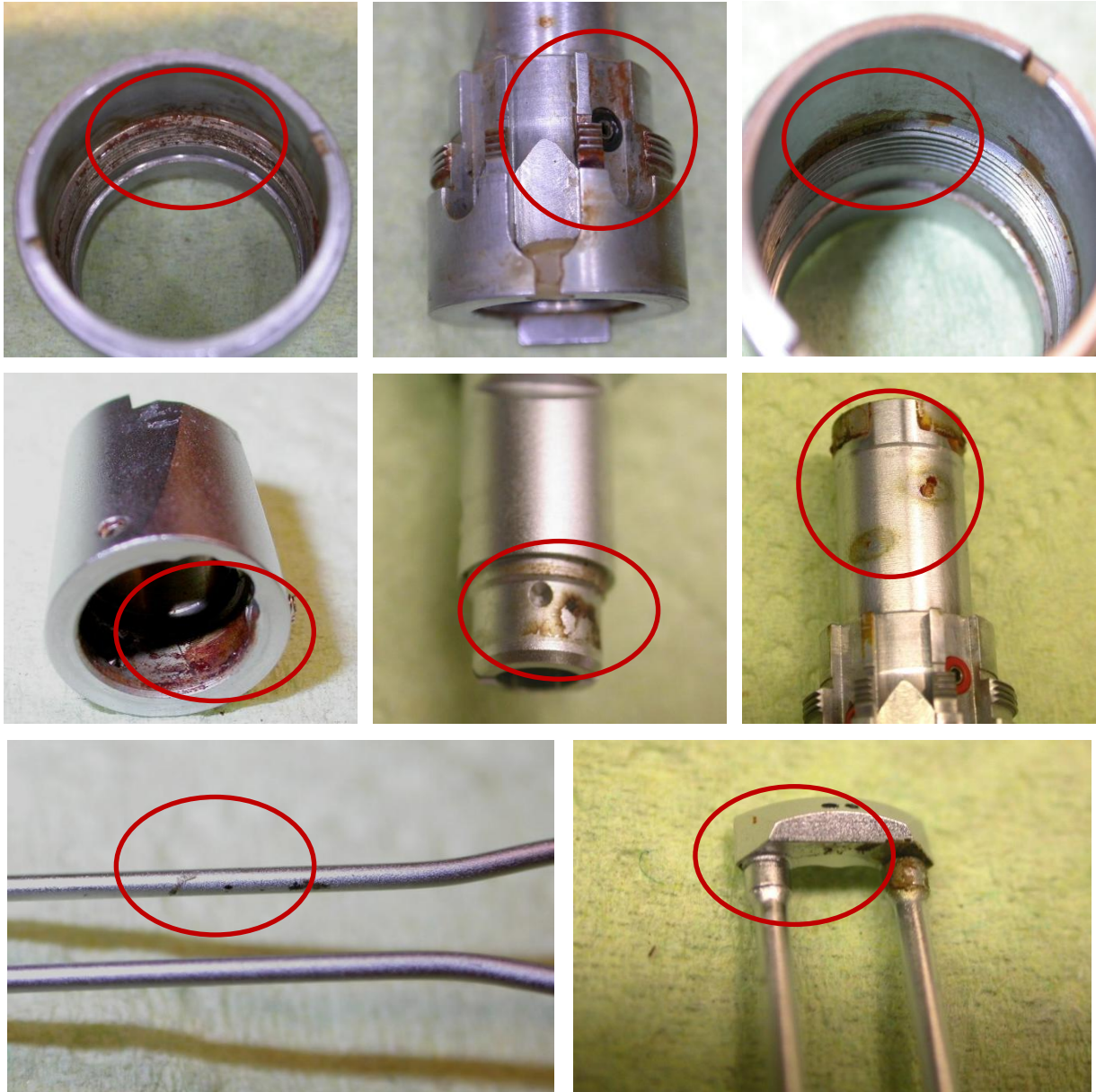
Abb. 4.3: Innenflächen der HWS und Außenflächen der Spraykanäle nach Aufbereitung im RDG1 mit dem Programm Vario TD
