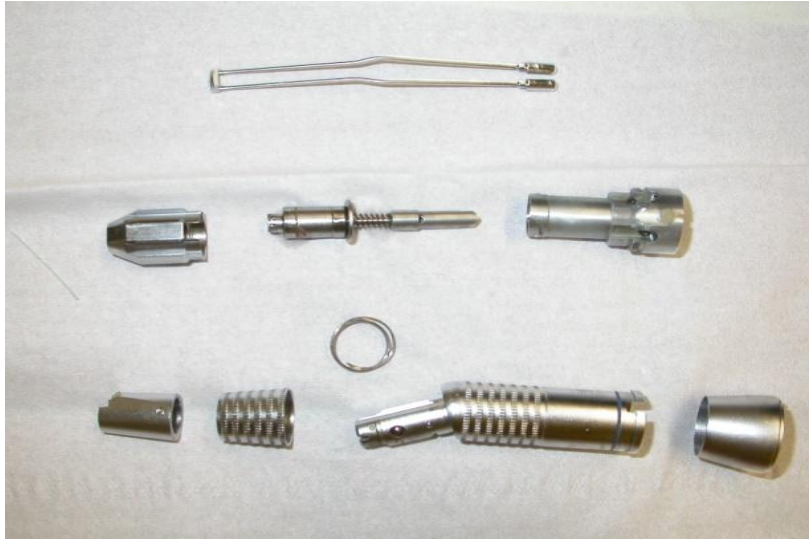
Abb. 3.1: Zerlegtes blaues Winkelstück ohne Kopf und Lichtleiter
